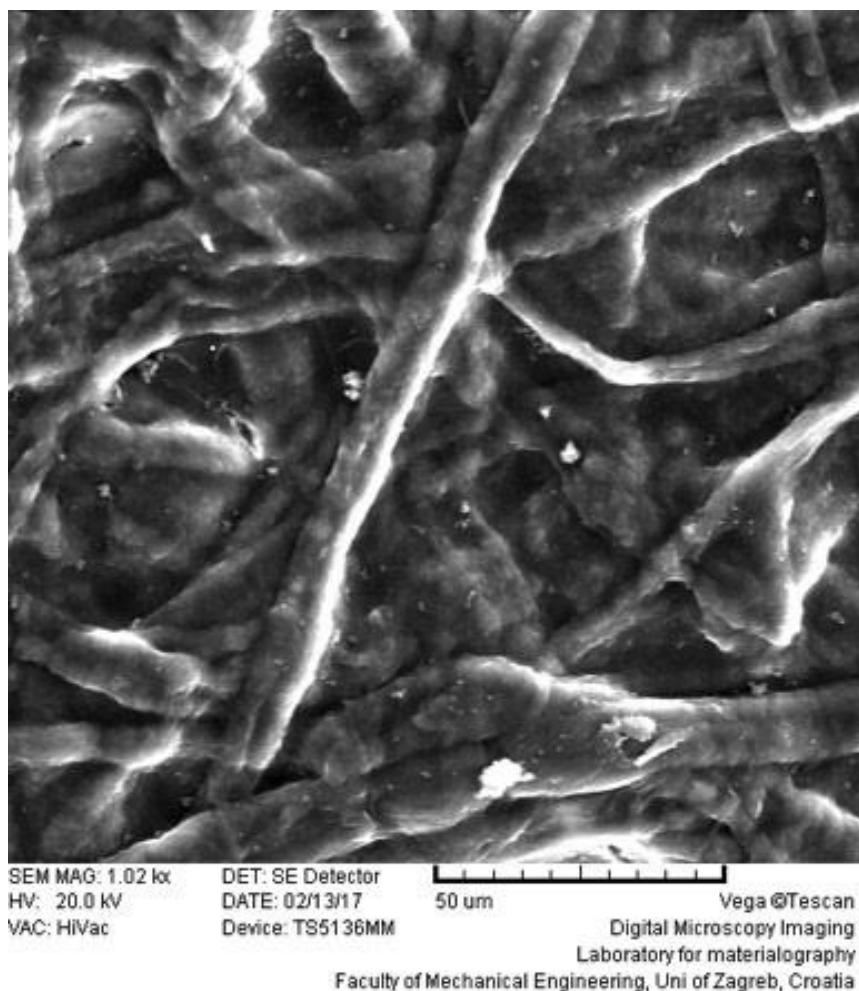
**Slika 12.** SEM snimka biofilmova *E. faecalis* na filter papirnatim diskovima (povećanje 1000x)
